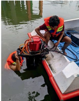
Pengujian Electric Outboard drivetrain di Kolam Uji Politeknik Pelayaran Surabaya
