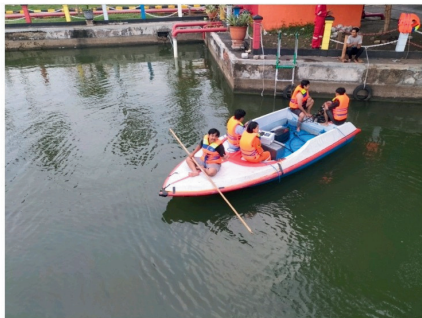
Pengujian electric outboard drivetrain pada kapal di kolam uji
